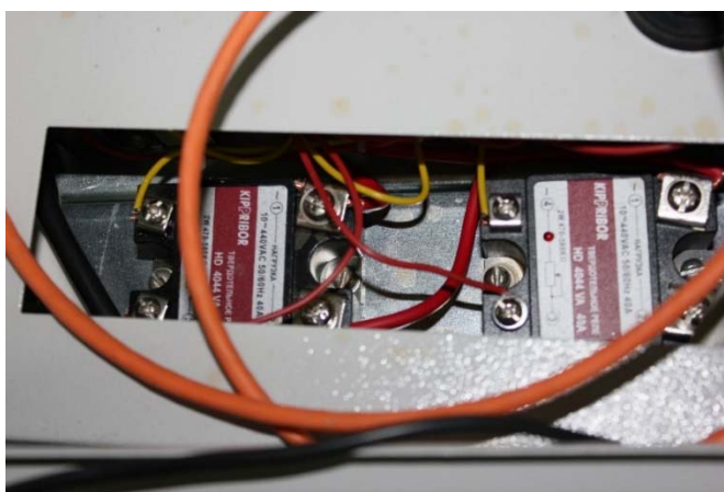
Рисунок 4.4 Твердотельные реле KIPPRIBOR HDH-xx44.ZD3
